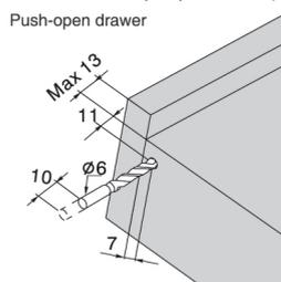
**Installazione del dispositivo di chiusura (mm)**
