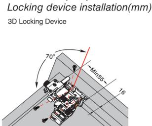
**Posizione del foro di fissaggio per cassetto interno (mm)**
